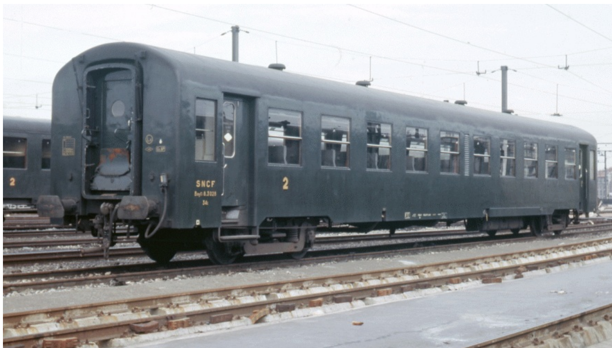
Voiture USI 60 - Bsmfyi (future B10t) chaudron court et soufflets - Epoque III
