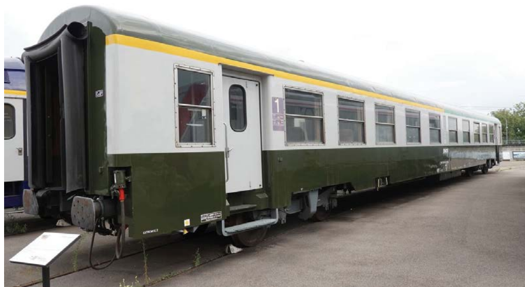
Voiture USI 68-71 - A4t4, transformée en A2t2B2t3 mixte
