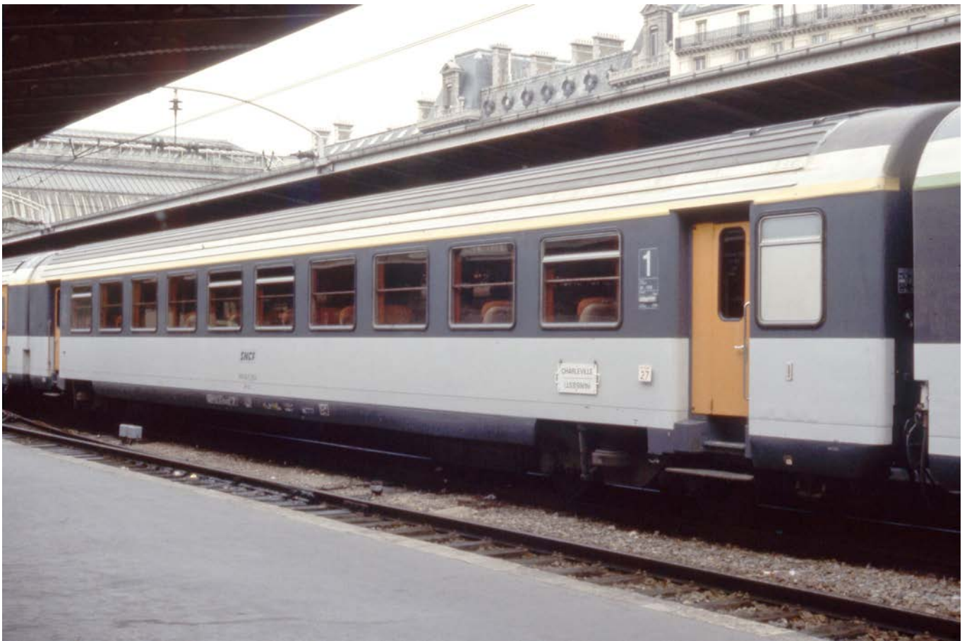
VTU 75 - A10tu à portes pliantes Mielich
