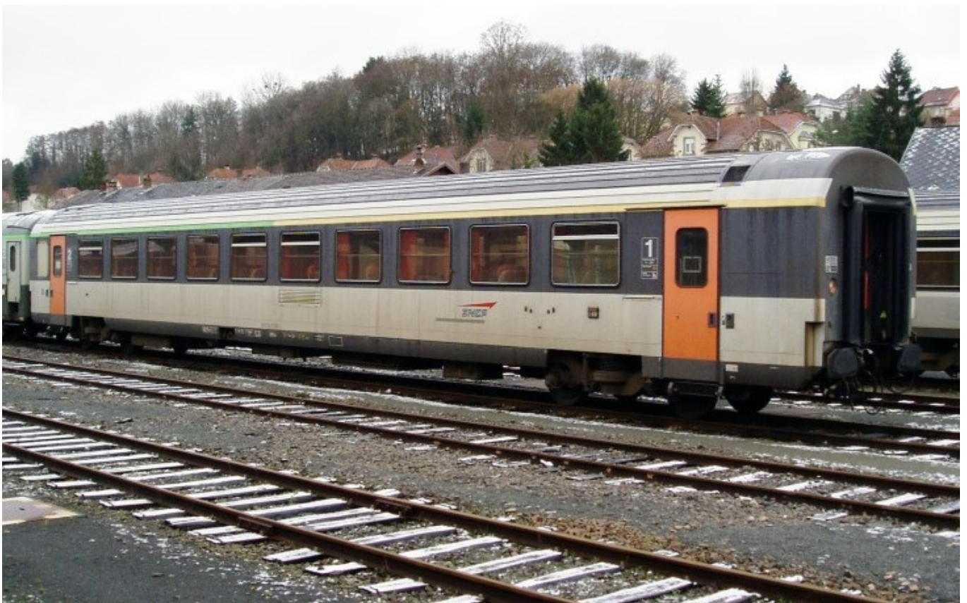
VTU 84 - A5B5tu à portes louvoyantes coulissantes (plc)
