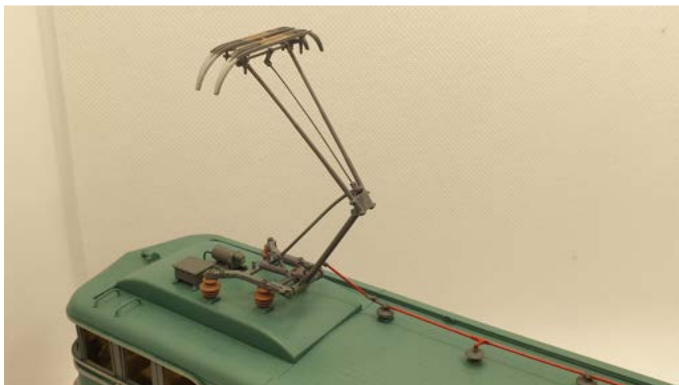
Le pantographe AM14, avec sa fixation quadri-pieds sur réhausse et son cadre supérieur non renforcé
