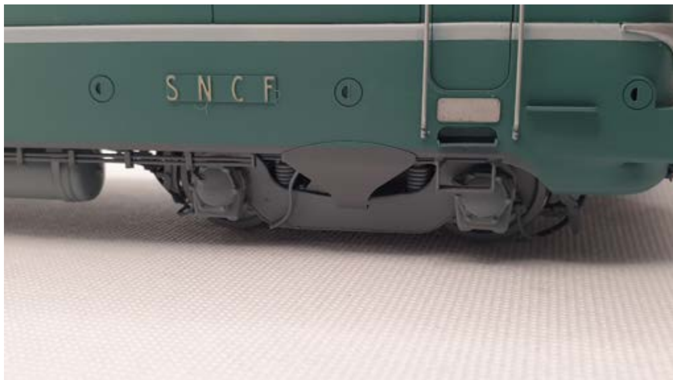
Le bogie, avec ses boîtes Athermos
