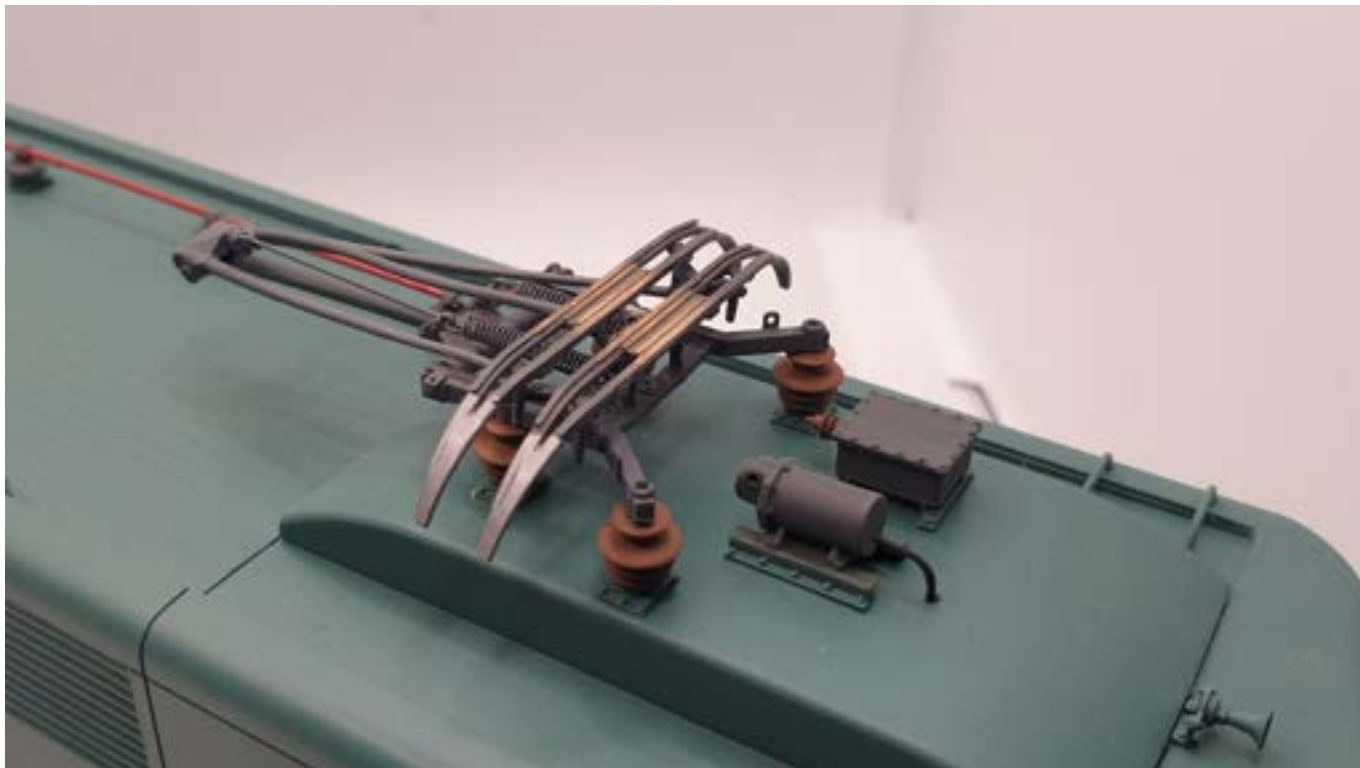
Le panto replié. On remarque l'absence de la barre de relevage entre l'axe inférieur et le servomoteur
