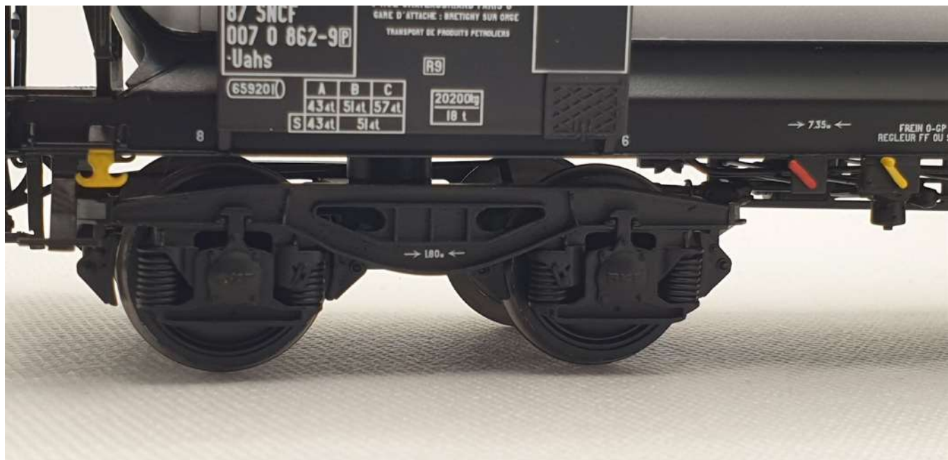
Bogie Y 25 S - Entr'axe de 1,80 m
