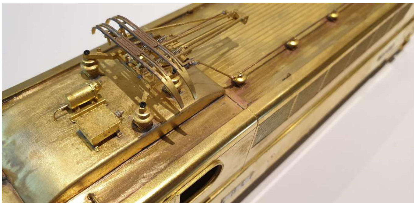
Toiture BB 9404 origine (manque l'arbre de liaison vérin/panto)
