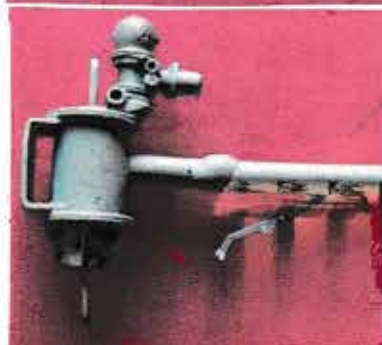
Cylindre de frein avec triple valve ref 0505
