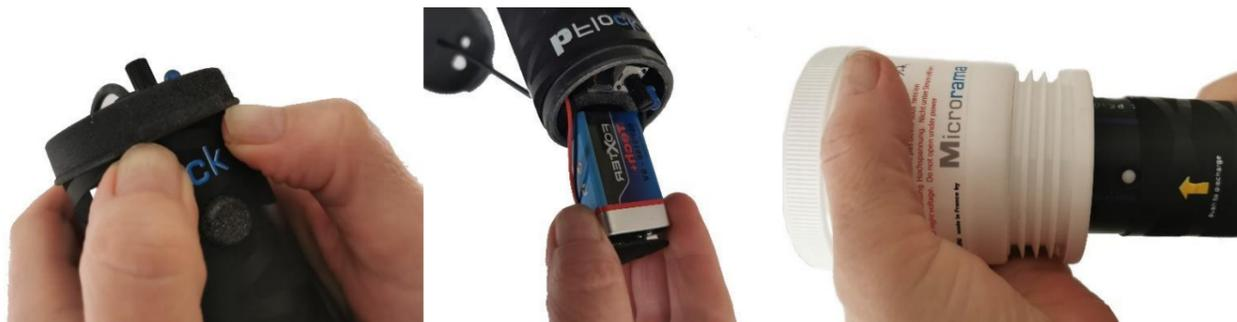
Zum Befüllen den jeweiligen Siebaufsatz abschrauben und den **bFlock 50** bis maximal zwei Drittel des Behältervolumens mit geeigneten, synthetischen Grasfasern befüllen. Die zu beflockende Fläche mit geeignetem Kleber, bzw. Leim bestreichen und einen Nagel oder eine Stecknadel im Leimbett fixieren. Daran wird nun die Krokodilklemme des Gegenpol-Kabels befestigt.
